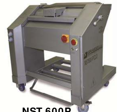
NST 600P Skinningmachine voor primals Rolbreedte 600 mm / grof Variabel diepte-instelling
