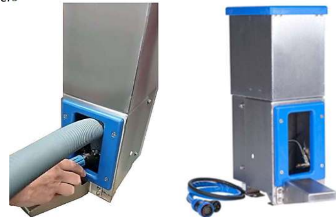
* Desinfectie-eenheid t.b.v. handstukken reuzelresten & ruggenmerg (gebruikt 90°C. water kan mee worden opgezogen in slang)
